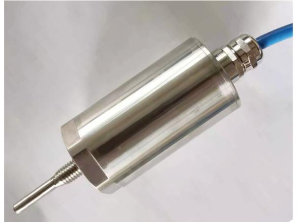
ZVS750 一体化振动温度传感器敏感部分采用加速度芯片和铂电阻测温元件输出原始信号，通过专业的信号处理及一次积分电路时振动信号转换为对应振动速度的交流信号和温度信号，通过高精度的模数转换，最终转换为两路标准的 4-20mA 电流信号。ZVS750 一体化振动温度传感器采用采用低功耗器件和电路，两线制输出，提高稳定性和使用寿命。产品结构紧凑，同时由于传感器和处理电路集成一体，，避免了信号的长距离传输，从而提高了抗干扰能力。
