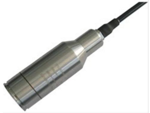
YWB160 电容投入式液位变送器采用高性能压力传感器作为测量元件，通过压力传感器，把与液位深度成正比的液体静压力准确测量出来，经过专用信号调理电路转换成标准信号输出，从而建立起输出信号与液体深度的线性关系，实现对液体深度的准确测量。由于采用了无油干式压力测量技术，充分发挥了陶瓷电容的技术优势，使 YWB160 电容液位变送器具有抗过载和抗冲击能力强，测量精度、可靠性高，长期稳定性好等特点。
