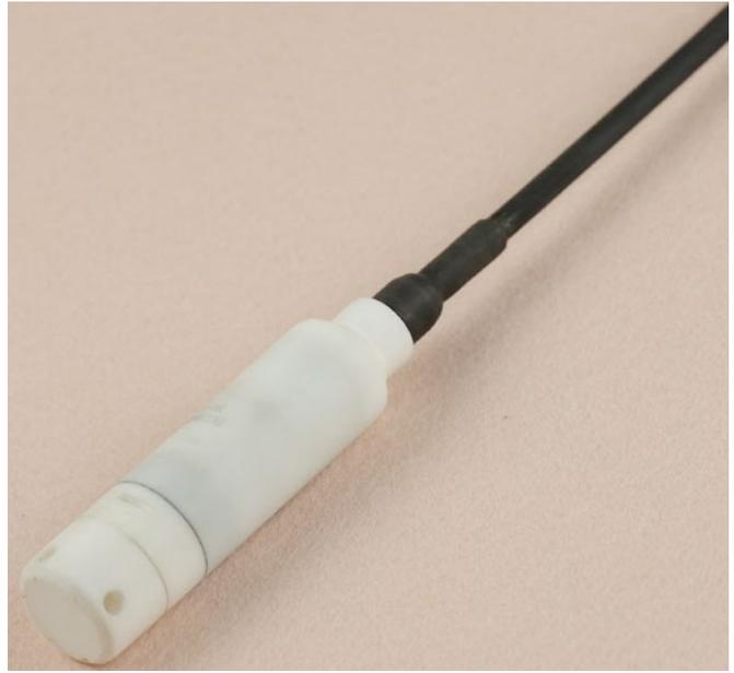
YWB040 投入式防腐型液位变送器是 ZLM620 通用液位变送器的防腐型，采用了完善的防腐设计，所有与被测介质接触的材料采用了聚四氟乙烯外壳，陶瓷膜片，氟胶密封，聚氨酯电缆，这些材料都具有很强的耐酸碱能力，因此 YWB040 具有真正的防腐蚀能力。YWB040 采用全密封潜入式设计，产品具有性价比高、体积小、重量轻、可靠性高，长期稳定性好等特点。此外，产品采用了二级防雷设计，非常适合露天场合的液位测量，现已广泛应用于水、油、酸、碱、盐等腐蚀性流体的液位测量。
