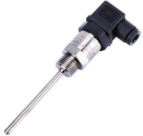
CWB130 是一款通用型温度变送器，在一般工业应用中可用来测量制冷与空调、压缩机组、冷却水、液压油等介质温度。最高测量温度可达 450 度，同时、多种模拟信号与数字信号输出可供选择。数字信号包括 RS485、CAN, IIC, TTL 等，更方便用户与其他设备组成测控系统。
